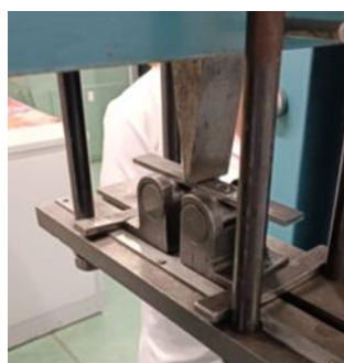
Рисунок 11 – Испытания образцов на проверку трещиностойкости листопроката а) схема расчета угла изгиба; б) испытание образца; в) образец с трещиной при изгибе на 130°
