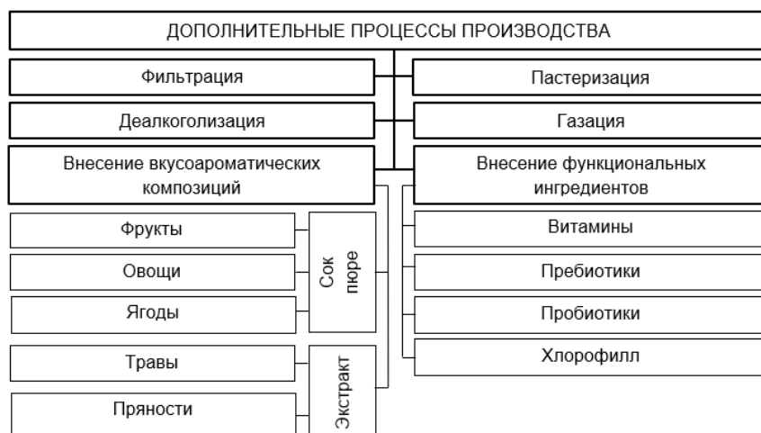
Рисунок 2 – Дополнительные процессы технологической схемы производства безалкогольных ферментированных напитков на основе чайного гриба
