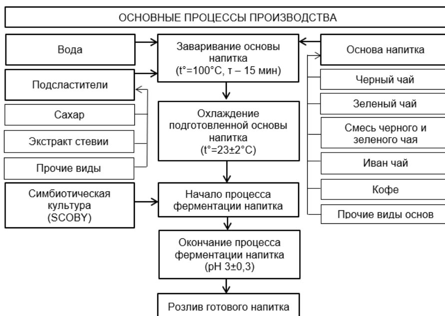
Рисунок 1 – Основные процессы обобщенной технологической схемы производства безалкогольных ферментированных напитков на основе чайного гриба
