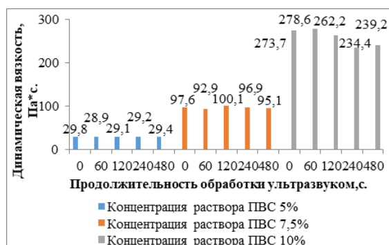
Рисунок 1 – Зависимость динамической вязкости Растворов ПВС с концентрацией 5 %, 7,5 % и 10 % от времени обработки ультразвуком
