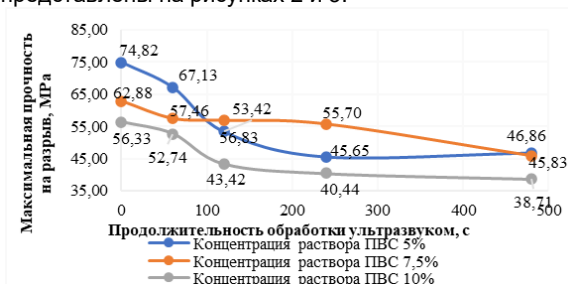
Рисунок 2 – Зависимость максимальной прочности на растяжении пленок на основе растворов ПВС от времени обработки УЗ
