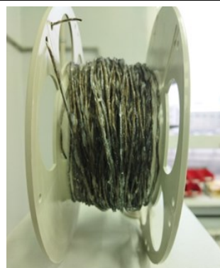
Рисунок 2 – Образцы филамента из Сэвилена СЭВ 11808-340 и базальтового волокна
