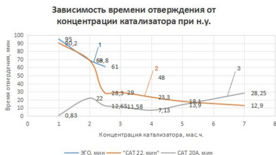
Рисунок 1 – Зависимость времени отверждения от концентрации катализатора при н.у.: 1 – ЭГО, 2 – CAT 22, 3 – CAT 20A
