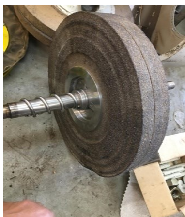
4. Неравномерная выработка поверхности
