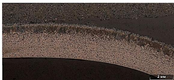
Рисунок 2 – Оптическое изображение области разрушения металлокомпозита после испытаний на адгезию металлокерамической составляющей металлокомпозитного брикета методом трехточечного изгиба
