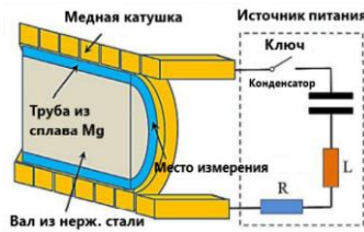
Рис. 9. Схема ЭИО при залечивании трещин бесконтактным способом (взято из [19])
