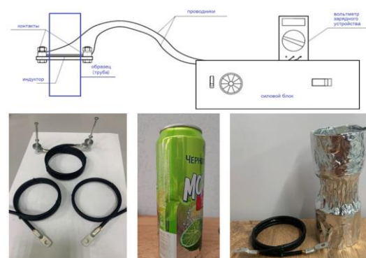
Рис. 24. Схема установки и подвода тока при бесконтактном способе ЭИО, индукторы и образцы Fig. 24. Installation and current supply diagram for the contactless EPT method, inductors and samples
