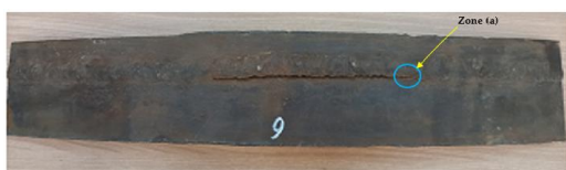
Рис. 4. Фрагмент дефектной газовой трубы из стали 17G1S (взято из [12]).
