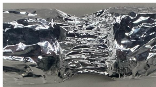
Рис. 6. Локализованная деформация цилиндра из пяти слоев алюминиевой фольги, инициированная импульсом тока в индукторе.
