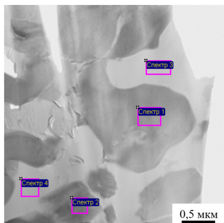
Рис.2. ПЭМ изображение формирующейся области контакта сплава 5083 (подложка) с ВЭС (покрытие); в таблице приведен элементный состав данного участка фольги
