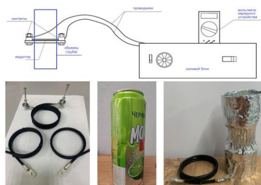
Рис. 24. Схема установки и подвода тока при бесконтактном способе ЭИО, индукторы и образцы
