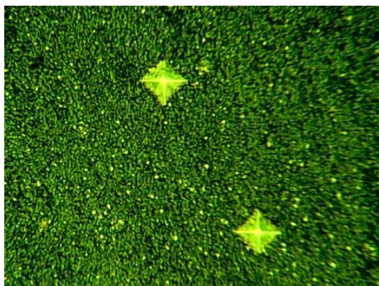
图 3 Ni-B 镀层表面硬度 (1h) Fig. 3. Surface hardness of Ni-B coating (1h)
