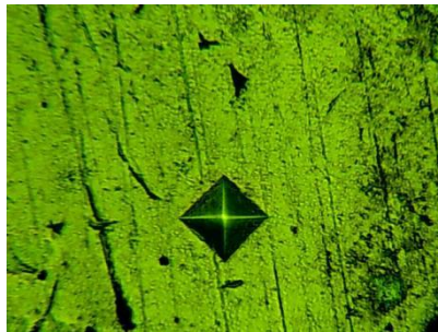
图 3. 硬度测试 Fig. 3. Hardness test
