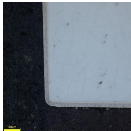
图 5. 镀层厚度 Fig. 5. Coating thickness
