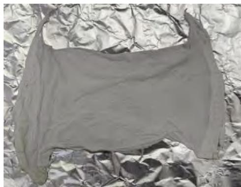
图 5 20wt% TPU 纤维压膜
