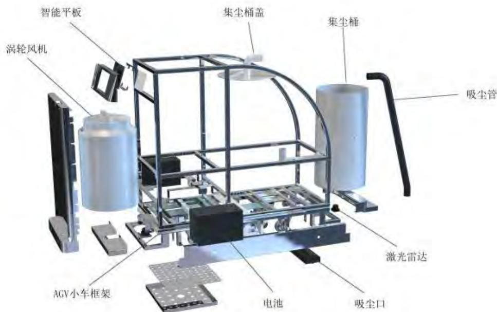
图 4 清扫机器人整体结构
