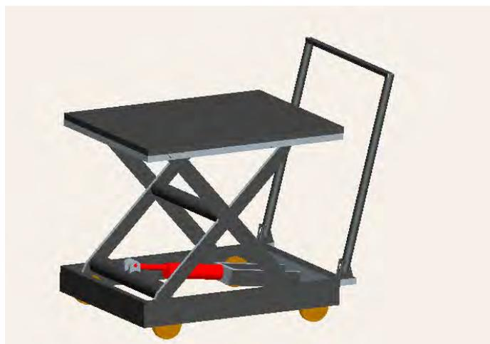
图 1 液压小车结构示意图
