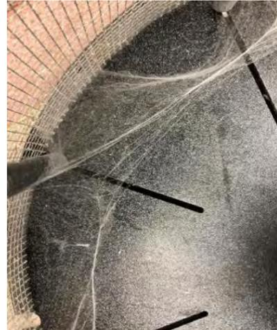
图 3 18wt% PAN/PMMA 80:20 纤维
