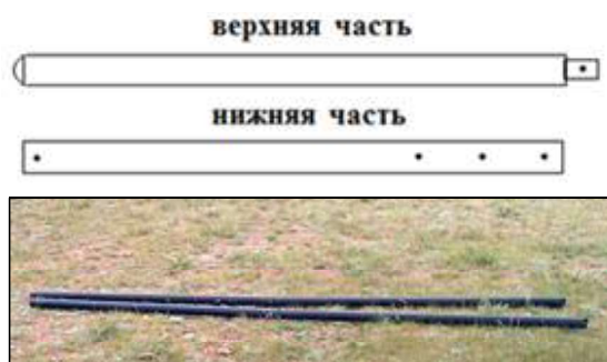
Рисунок 5 – Конструкция составного репера для закладки в Кош-Агачском районе Республики Алтай
