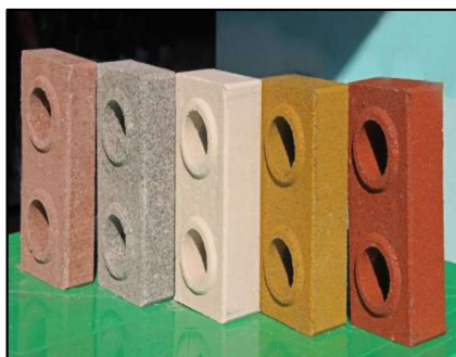
Рисунок 2 — Вид кирпича после применения различных красителей для улучшения внешнего вида сооружения
