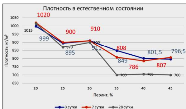
Рисунок 3 – Влияние состава теплоизоляционного штукатурного раствора на плотность в естественном состоянии
