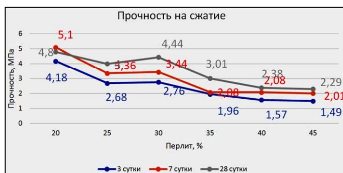
Рисунок 1 – Влияние перлита на прочность при сжатии
