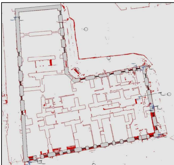
Рисунок 4 – Проверочный вид плана этажа, совмещенный с облаком точек
