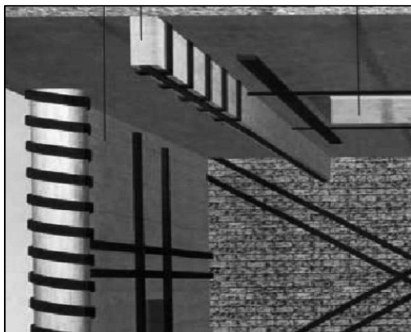
Рисунок 1 — Пример усиления здания углеволокном
