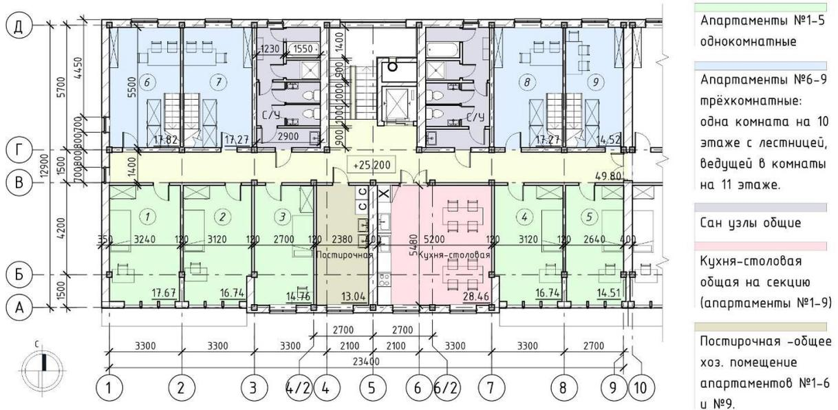
Рисунок 20 – План секции 10 этажа
