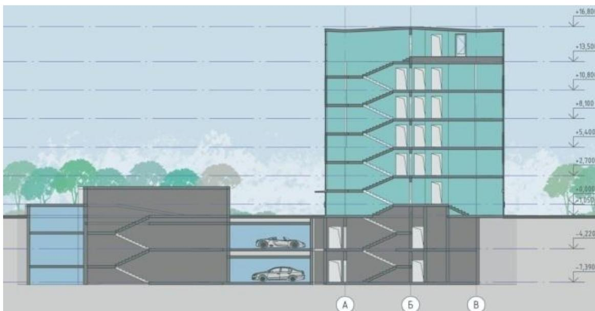
Рисунок 28 - Поперечный разрез (с функциональными зонами)
