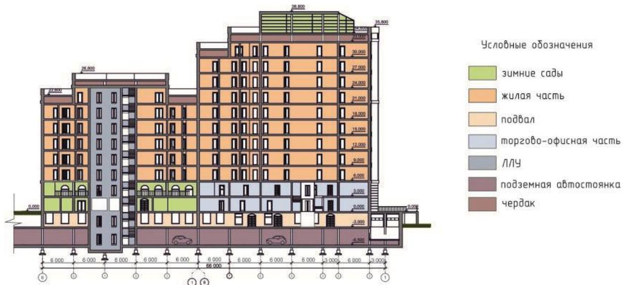
Рисунок 15 – Разрез с функциональным зонированием вдоль пр. Комсомольского
