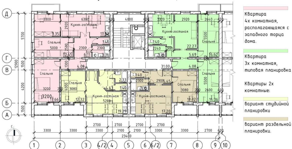
Рисунок 19 – План торцевой секции 1-9 этажи
