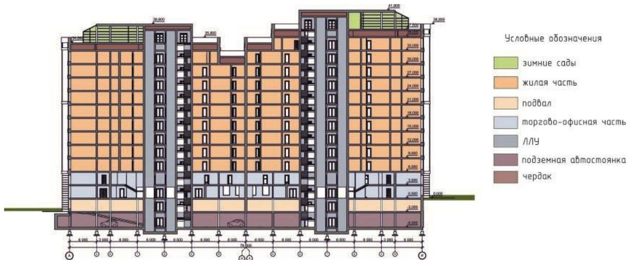
Рисунок 14 – Разрез угловых секций с функциональным зонированием
