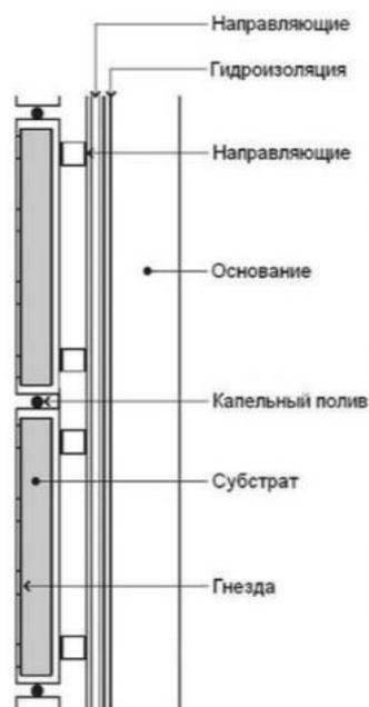
Рисунок 4 – Пример устройства модульной системы
