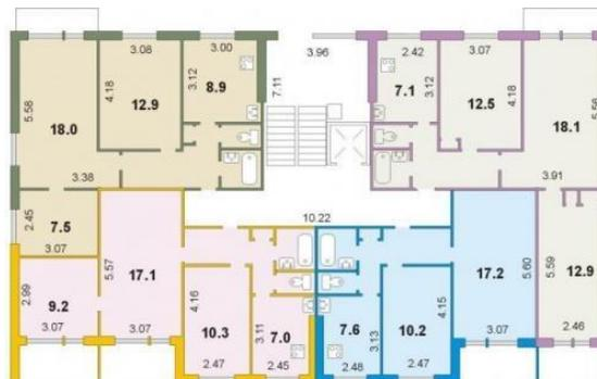
Рисунок 10 – Типовая планировка секции 464
