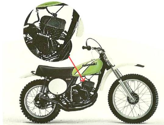
Рисунок 8 – Мотоцикл с увеличенным изображением системы охлаждения двигателя
