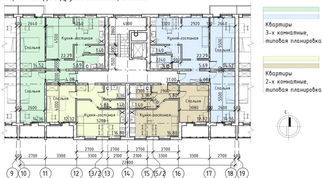
Рисунок 18 – План типовой секции 1-9 этажи
