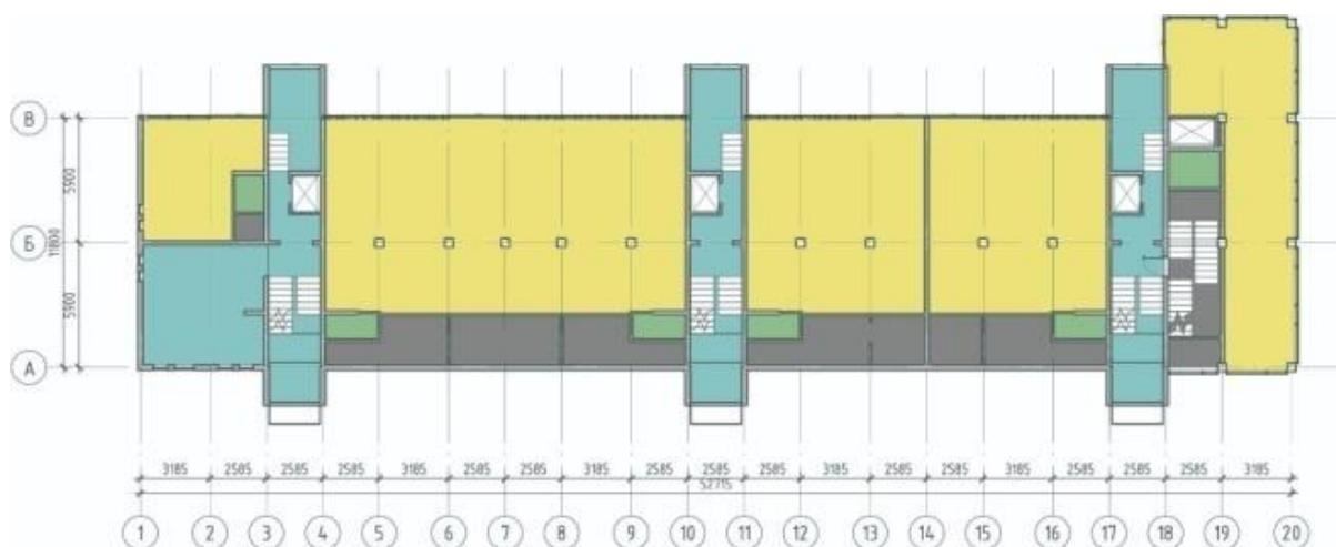
Рисунок 26 - Схема первого этажа после модернизации (с функциональными зонами)
