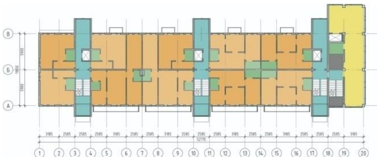
Рисунок 27 - Схема второго этажа после модернизации (с функциональными зонами)
