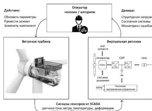
Рисунок 3 – Моделирование виртуальной реплики для ветряной турбины
