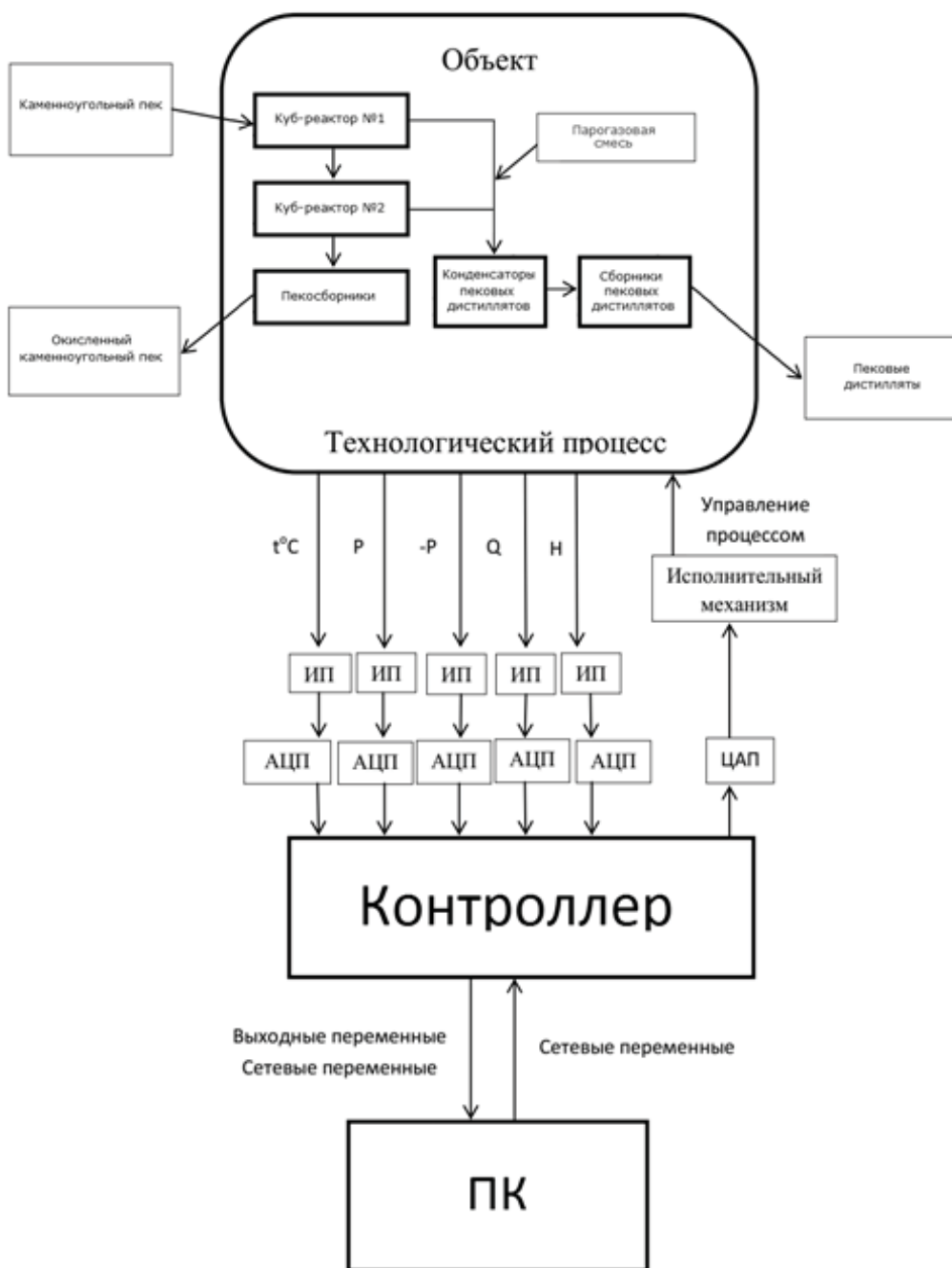
Рисунок 1 – Функциональная схема системы автоматизированного контроля окисления каменноугольного пека
