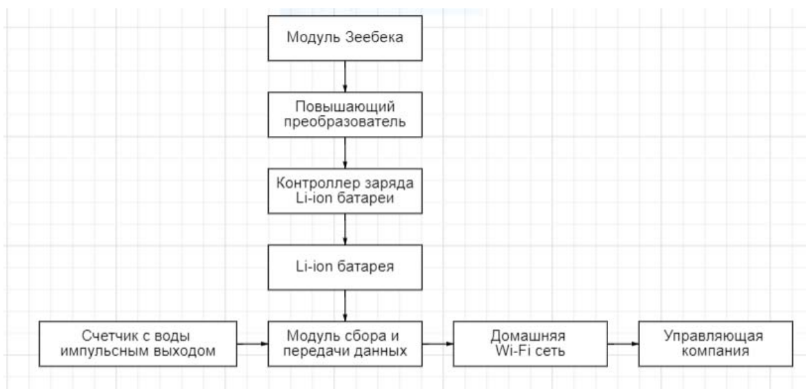
Рисунок 3 – Функциональная схема автономного блока питания для передачи показаний объема воды
