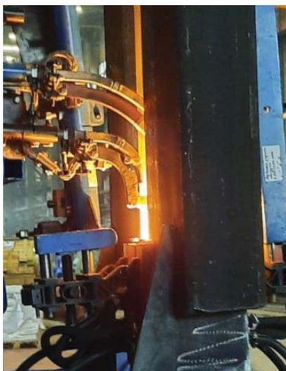
Рисунок 2 – Процесс электрошлаковой сварки контрольного сварного соединения
