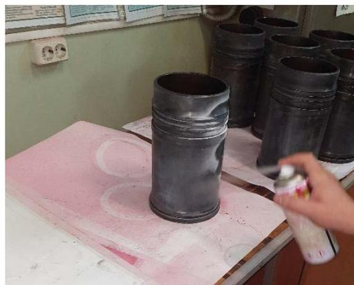
Рисунок 6 – Нанесение проявителя на внешнюю сторону стальной гильзы
