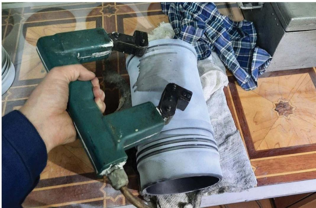
Рисунок 4 – Проведения магнитопорошковой дефектоскопии на стальных гильзах
