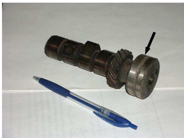
Рисунок 8 - Распределительный вал ДВС после ремонта методом электроннолучевой наплавки (стрелкой указано место износостойкой наплавки)
