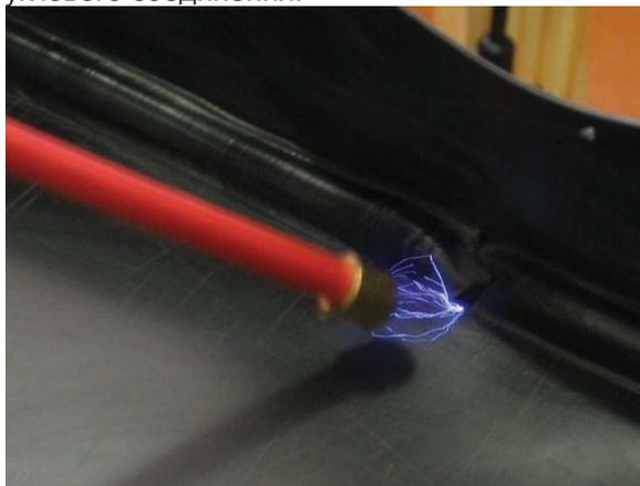
Рисунок 6 - Проверка герметичности углового шва, выполненного экструзионной сваркой (искровой разряд показывает нарушение сплошности шва)
