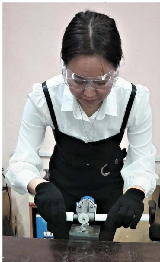
Рисунок 7 – Раструбная сварка полипропиленовых труб
