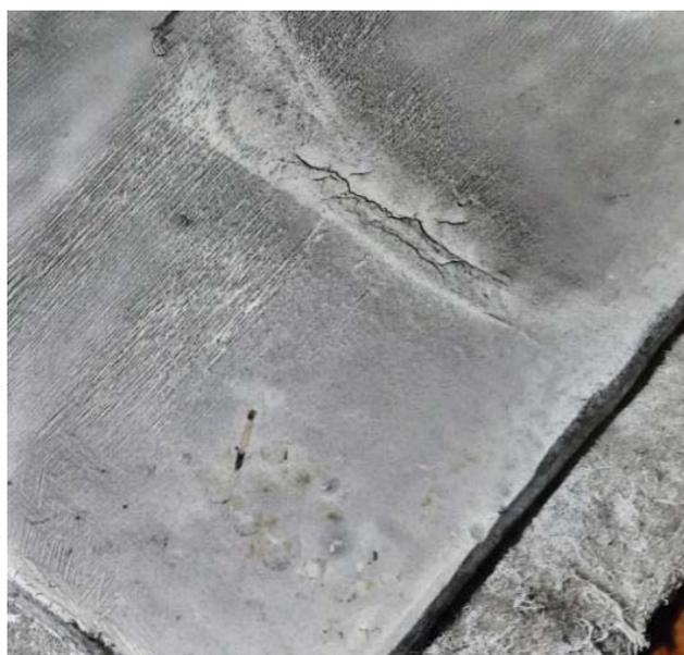
Рисунок 3 – Искусственная трещина для проверки корректной работы намагничивающего устройства
