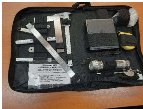
Рисунок 1 – Набор визуального и измерительного контроля «АРШИН СТАНДАРТ»
