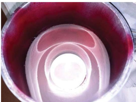
Рисунок 5 – Нанесение пенетранта на внутреннюю поверхность стальной гильзы
