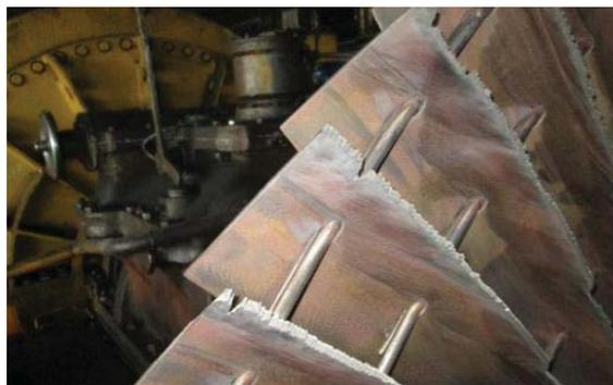
Рисунок 2 - Эрозионный износ ступени № 25 турбины Т-185/220-130-2. Кировской ТЭЦ-5 (вид с вогнутой стороны пера)
