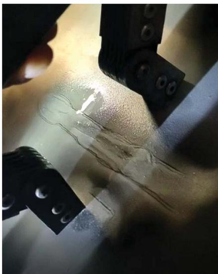
Рисунок 3 – Проведение магнитопорошкового контроля
