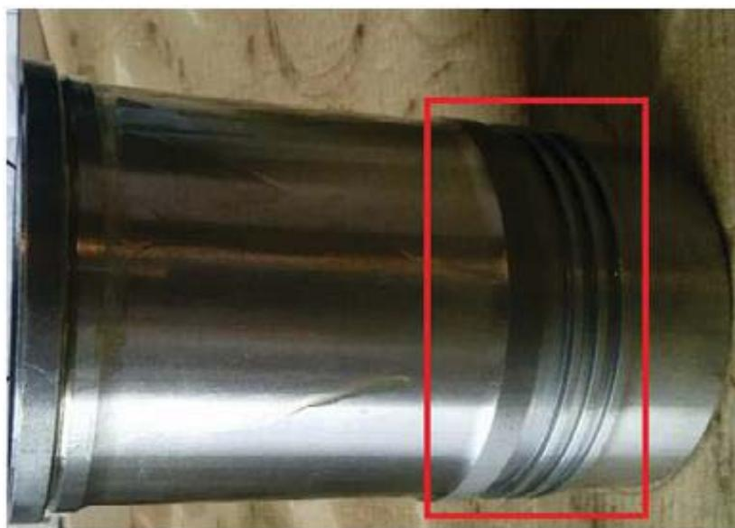
Рисунок 2 – Технологические буртики гильзы
