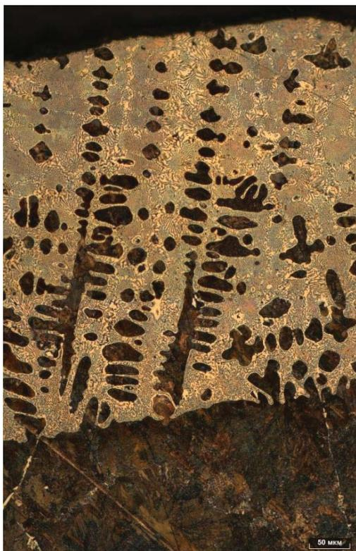
Рисунок 2 - Микроструктура наплавленного слоя при силе сварочного тока 120А
