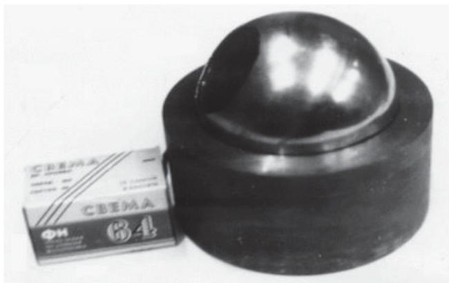
Рисунок 1 - Запорная арматура с уплотнительными поверхностями, упрочненным методом ЭЛН в вакууме
