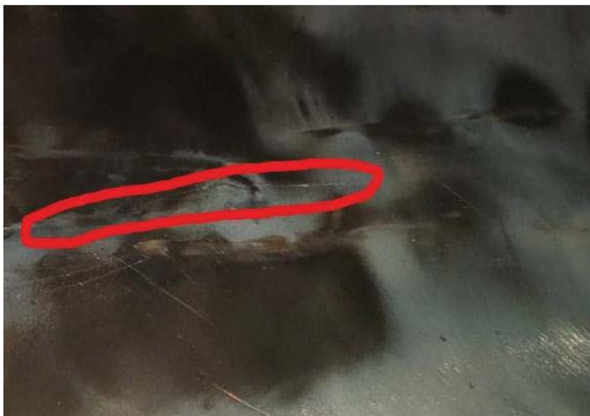
Рисунок 2 – Трещина, выявленная в ходе визуального и измерительного контроля
