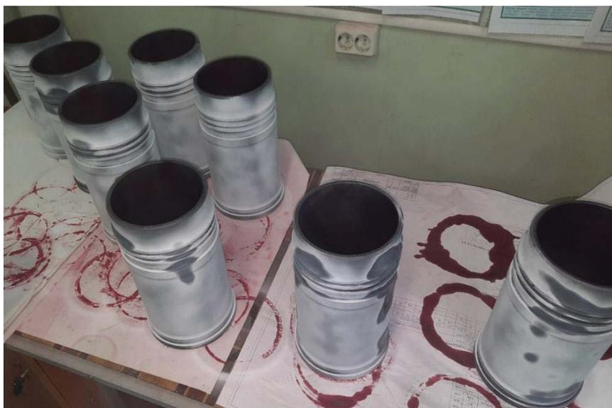
Рисунок 7 – Стальные гильзы после нанесения проявителя
