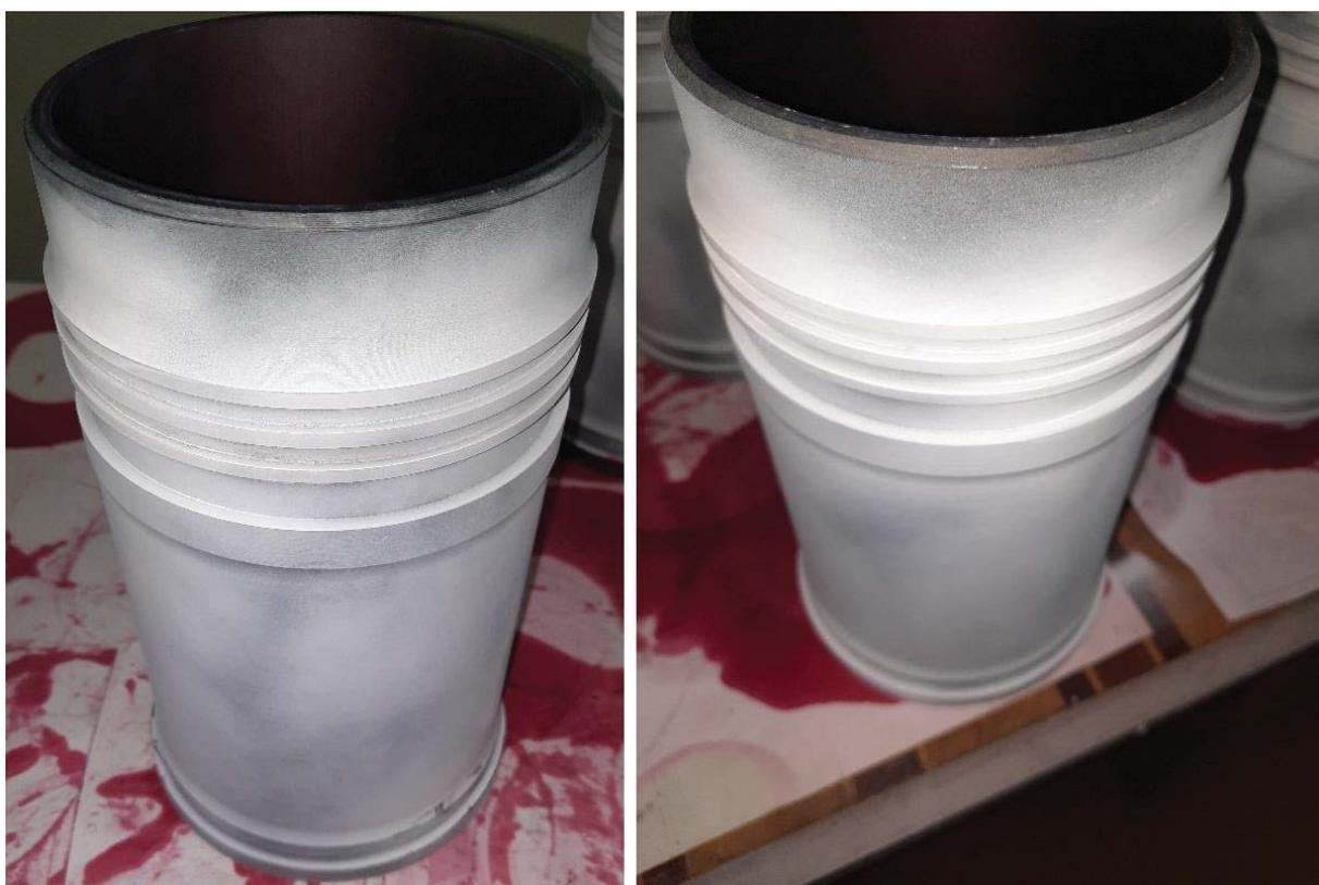
Рисунок 8 – Проверка проникновения пенетранта на поверхность проявителя
