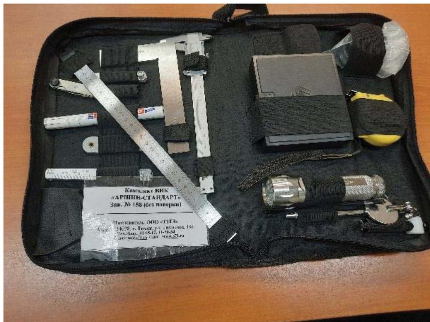
Рисунок 1 – Набор визуального и измерительного контроля «АРШИН СТАНДАРТ»
