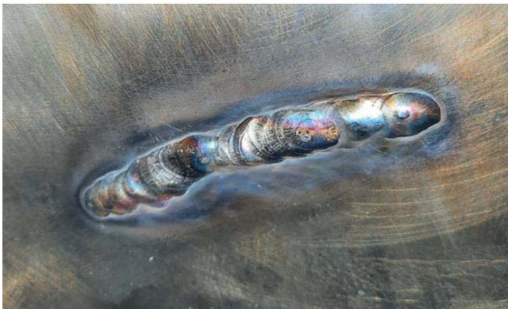
Рисунок 7 – Ремонтный сварной шов
