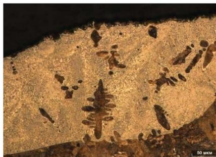
Рисунок 1 - Микроструктура наплавленного слоя при силе сварочного тока 80А
