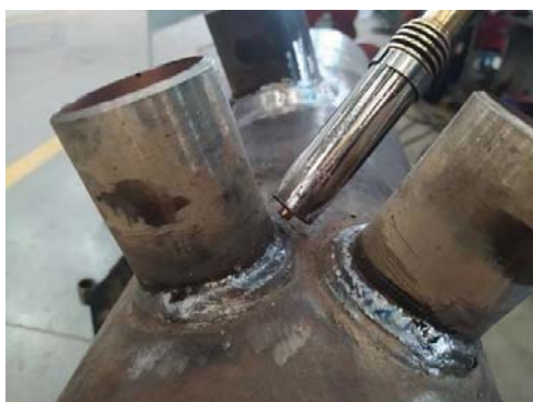
Рисунок 2 – Доступность зоны сварки для горелки в радиальном направлении
