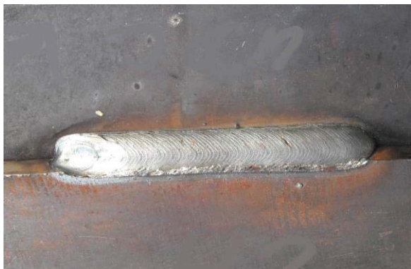
Рисунок 5 – Угловой шов катетом 10 мм, полученный за один проход в положении Н2
