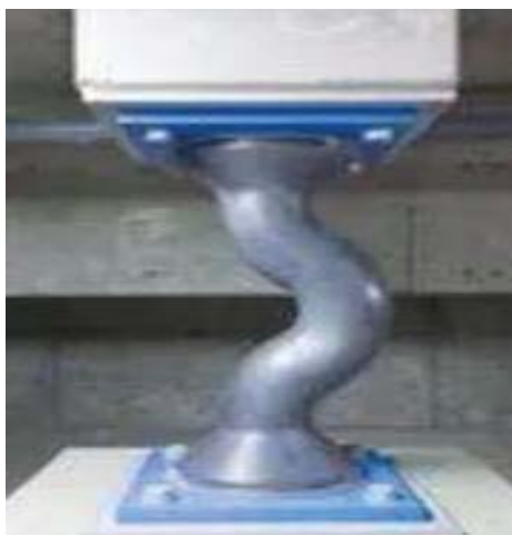
Рисунок 2 – Фундаменты с использованием заменяемых предохранителей
