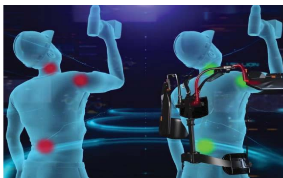
Рисунок 5 – Компенсация нагрузок с помощью пассивного экзоскелета
