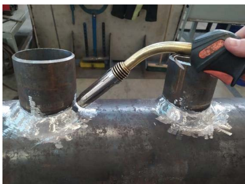
Рисунок 1 – Доступность зоны сварки для горелки в осевом направлении
