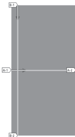
Рисунок 4 – Траектории сбора значений остаточных окружных напряжений
