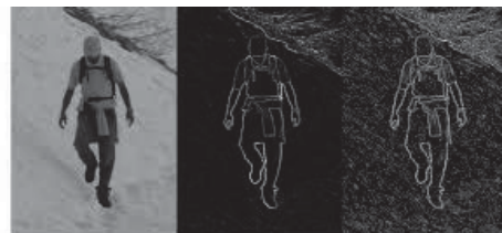
Рисунок 3 – Работа алгоритма контурного анализа
