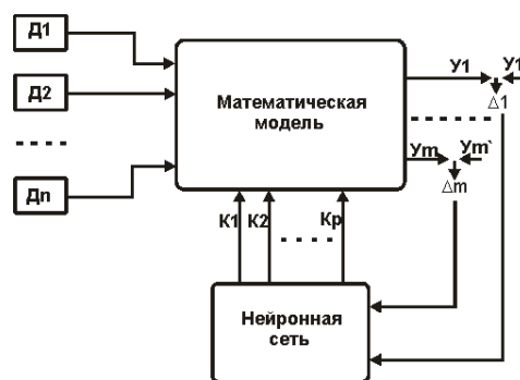
Рисунок 2 – Структурная схема интеллектуального прибора с настраиваемой моделью
