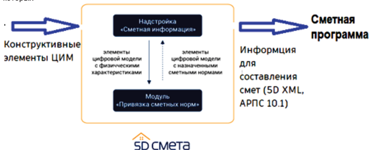
Рисунок 1 – Схема работы программы 5D смета
