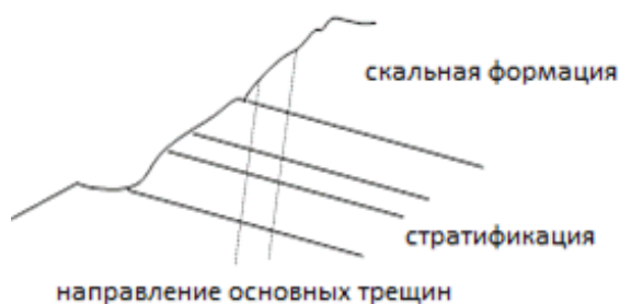
Рисунок 6 – Схема модели трещиноватой скалы
