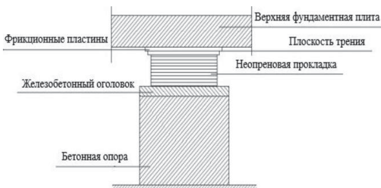
Рисунок 10 – Сейсмоизолирующий фундамент фирмы Spie Botignolle
