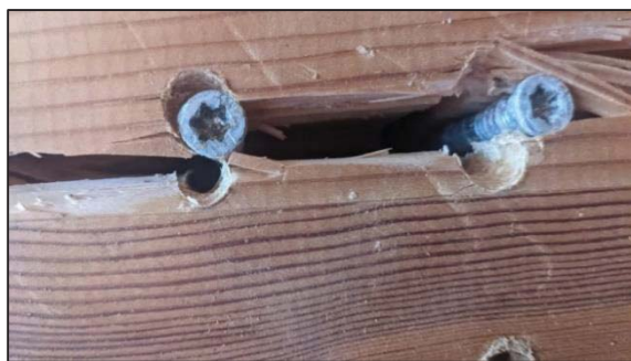
Рисунок 8 – Раскалывание древесины вдоль волокон по оси продольного ряда саморезов
