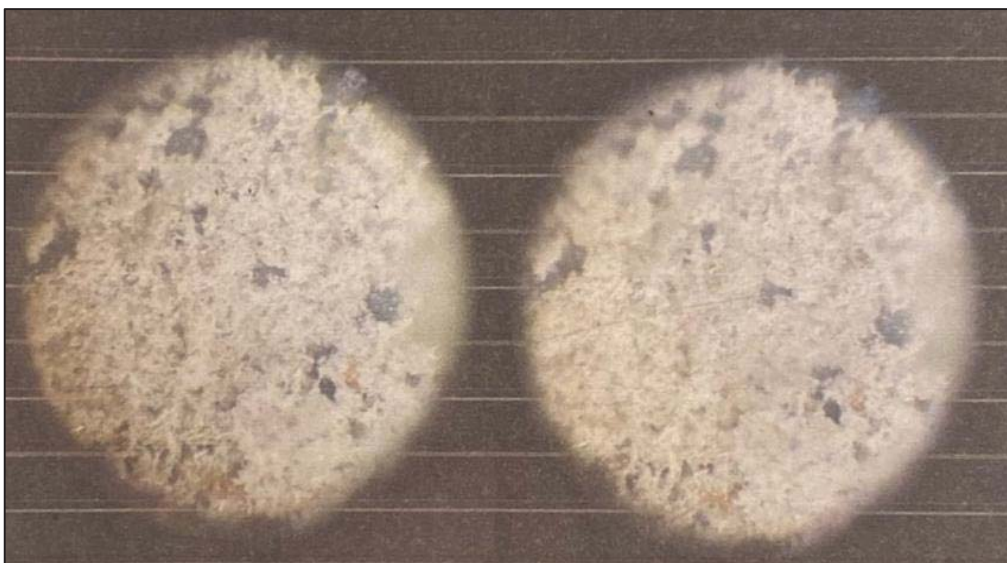
Рисунок 1 – Вид добавки «Nisoflok» при 56 х кратном увеличении через микроскоп
