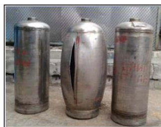
Рисунок 5 – Последствия воздействия избыточного давления на сосуд
