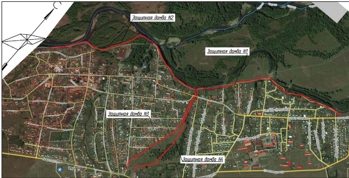
Рисунок 4 – Схема расположения защитных дамб для инженерной защиты с. Краснощеково
