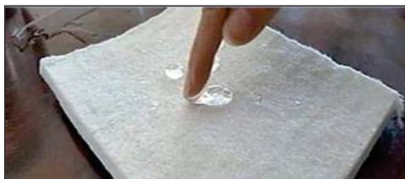
Рисунок 4 – Гидрофобный аэрогелевый композит
