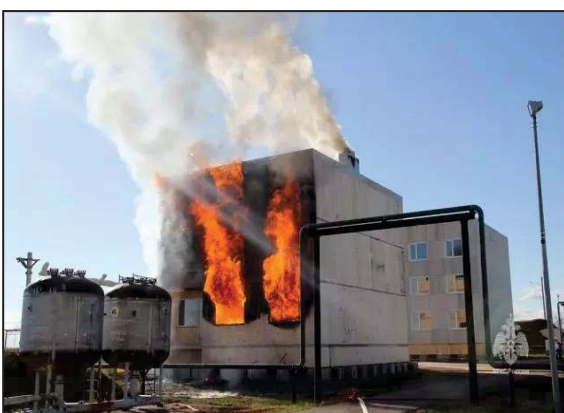
Рисунок 8 – Испытания дома из CLT конструкций на полигоне в г. Оренбург
