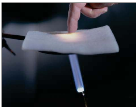
Рисунок 3 – Аэрогель под воздействием открытого огня
