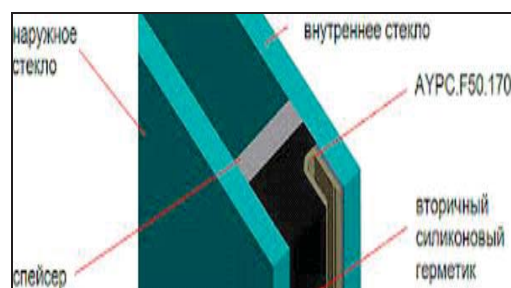
Рисунок 1 – Состав стеклопакета структурного остекления
