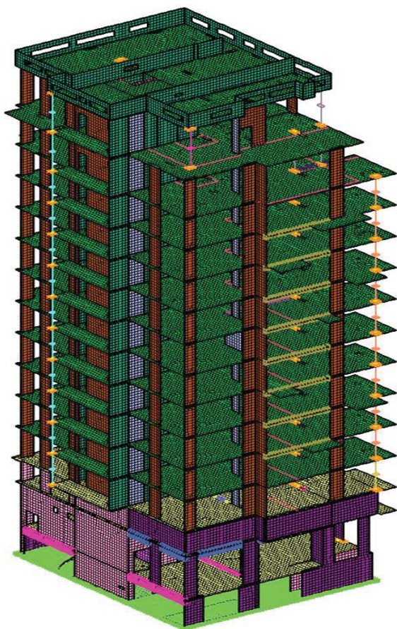
Рисунок 2 – Пространственная расчетная схема здания в расчетной программе
