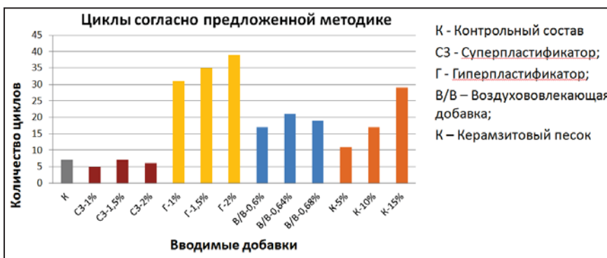
Рисунок 3 – Определение морозостойкости образцов с введением одной добавки
