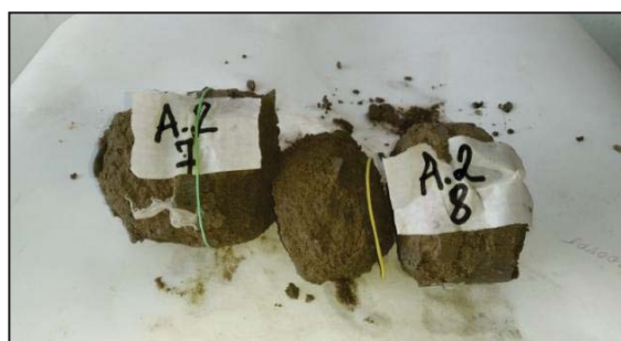
Рисунок 3 – Разрушение образцов, укрепленных одной ВКЗ
