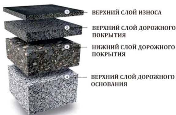
Рисунок 3 – Конструкция дорожной одежды со слоем износа
