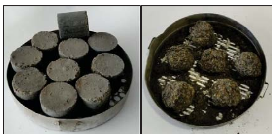
Рисунок 2 – Фото образцов с 25% ЗШС после 15 циклов испытания на морозостойкость. Слева – песок № 1, справа – суглинок № 2
