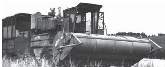
Рисунок 4 – Обмолот на корню с использованием МПУ-150 [5]
