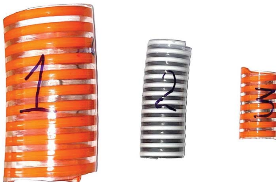
1 – шланг с внутренним диаметром 63 мм; 2 – шланг с внутренним диаметром 30 мм (не имеет дефектов, образец сравнения); 3 – шланг с внутренним диаметром 25 мм
