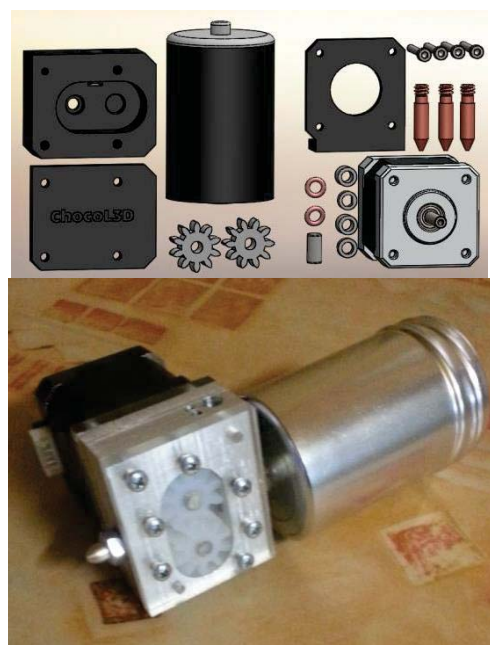
Рисунок 2 – Конструкция экструдера WaxL3D
