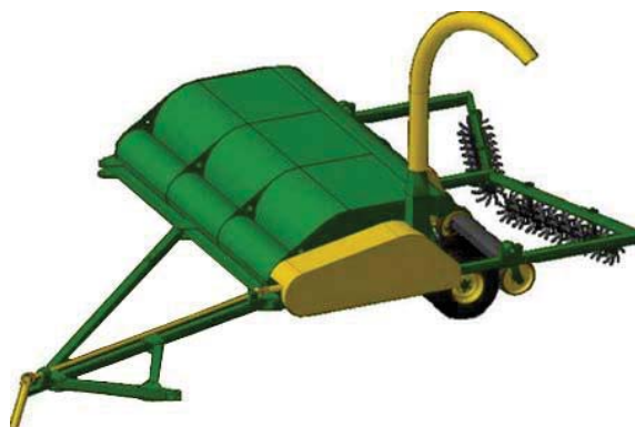
Рисунок 2 – 3D-модель энергоресурсосберегающего агрегата ЭРА-У [7]
