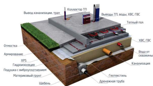
Рисунок 1 – Устройство утепленной шведской плиты:
