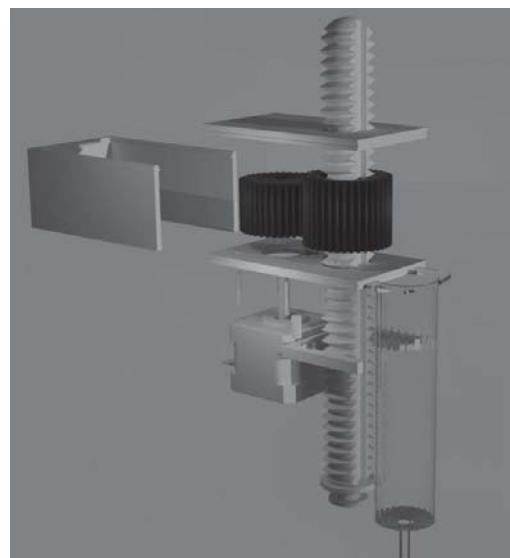
Рисунок 4 – Экспериментальная конструкция экструдера для печати восковок
