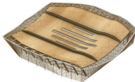
Рисунок 5 — Аксонометрическая модель деревянных конструкций крыши Центра
