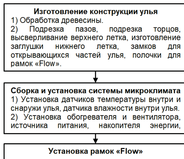
Рисунок 1 – Технологический процесс производства пчелиного улья с системами регулирования микроклимата и сбора мёда
