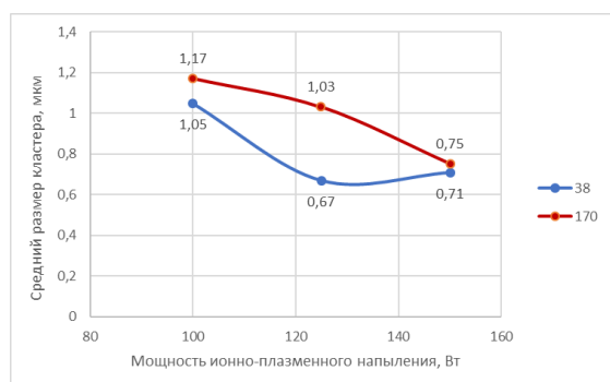
Рисунок 5 – Зависимость размеров кластерных образований от мощности ионно-плазменного распыления
