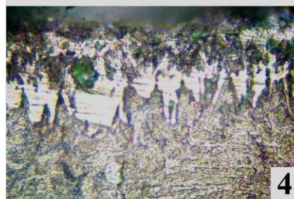
Рисунок 2 – Микроструктуры диффузионных слоев при борировании в смесях 3 и 4 (1000×)
