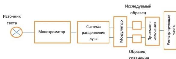
Рисунок 3 – Схема строения спектрофотометра
