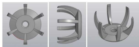
Рисунок 2 – Изображение формы звездчатого электрода
