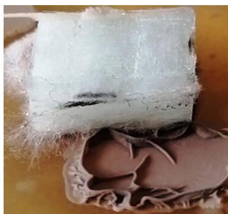
Рисунок 14 – Обрастание опытного образца стеклотекстолита колониями микроорганизмов
