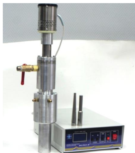
Рисунок 3 – Стенд с ультразвуковым технологическим аппаратом и технологическим объемом
