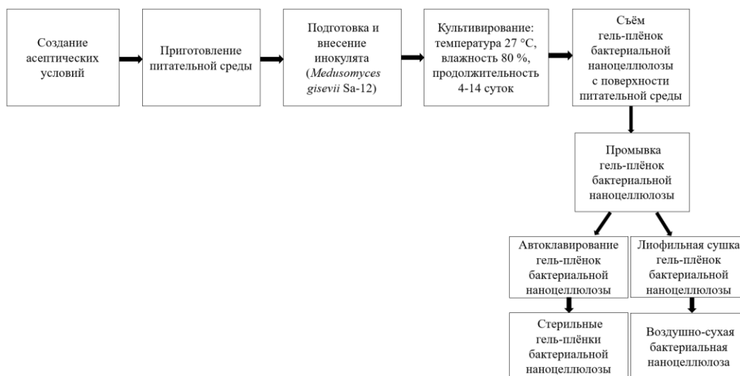
Рисунок 1 – Схема процесса получения бактериальной наноцеллюлозы Figure 1 – Schematic diagram of the process for obtaining bacterial nanocellulose
