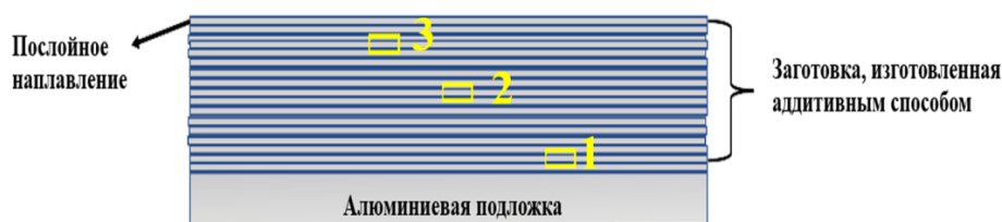
Рисунок 1 – Области исследования слитка из сплава AA7075, изготовленного проволочно-дуговым аддитивным способом: 1 – приграничная к подложке область; 2 – центральная область; 3 – периферийная область
