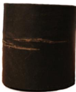
Рисунок 1 – Образец ( PbO_2 40 мас% +ПТФЭ 60 мас%) после термообработки при температуре 370 \pm 5^\circ C и выдержке 6 часов
