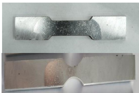
Рисунок 1 – Внешний вид образца алюминиевого сплава 7075 для механических испытаний после электронно-пучковой обработки
