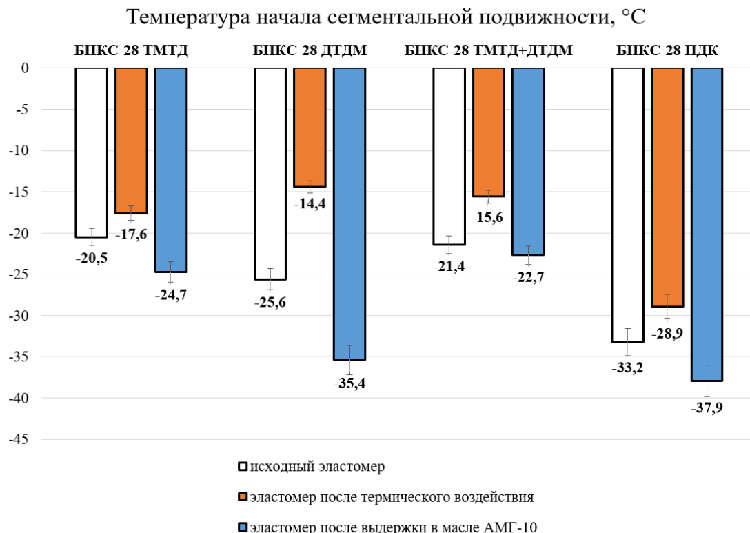
Рисунок 2 - Диаграмма начала сегментальной подвижности эластомеров на основе каучука БНКС-28 исходных образцов, после термического воздействия и выдержки в гидравлическом масле АМГ-10 в зависимости от вулканизирующей группы
