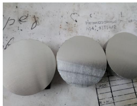
Рисунок 6 – Образцы после обработки после МАО
