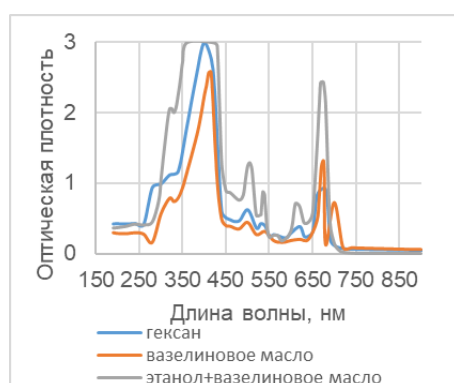
Рисунок 4 – Спектры поглощения экстрактов Hedophyllum bongardianum , полученных при использовании неполярных органических растворителей и двухфазного экстрагента
