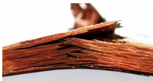
Рисунок 6 – Типовое разрушение на примере образца из пластины 3
