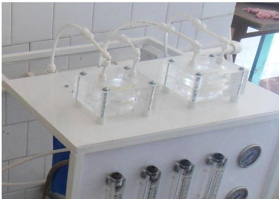
Рисунок 1 – Общий вид мембранных ячеек для исследования плоских мембран
