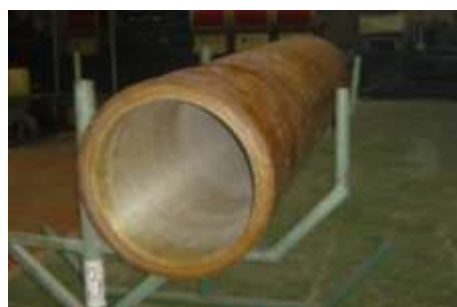
Рисунок 7 - Композитная труба, защищенная от внутреннего огневого воздействия применением гибридного композиционного материала
