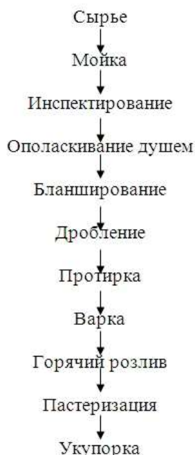
Рисунок 1 – Технологическая схема приготовления протертых масс без сахара
