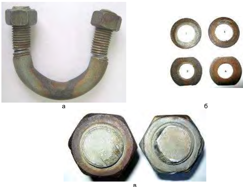
Рисунок 1 – Узел крепления КГП-16-1 (а); элементы резьбового соединения (б), где 1, 3 – шайбы, 2, 4 – шайба упорная; гайки (в)
