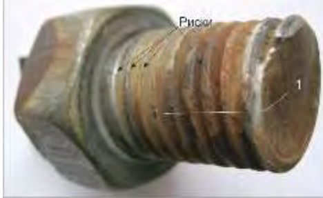
Рисунок 3 – Фрагмент узла, представленного на рисунке 2, б с деформированной резьбой, где 1 – линия плоскости шлифа, представленного на рисунке 4
