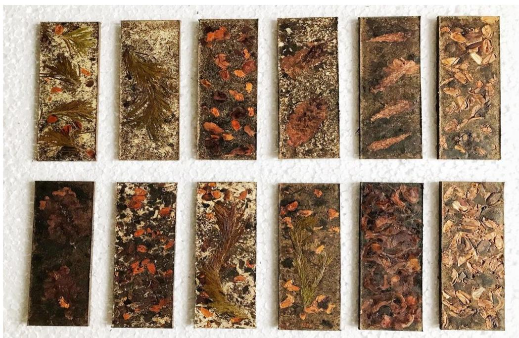
Рисунок 1 – Образцы плитных декоративных материалов (связующее – опилки сосны обыкновенной, обработанные по методу взрывного автогидролиза)
