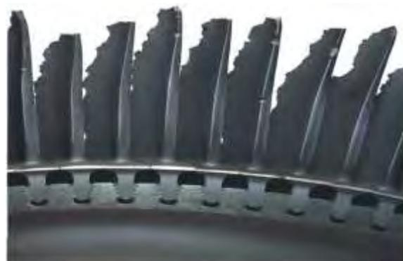
Рисунок 4 – Термоусталостное разрушение лопаток турбин
