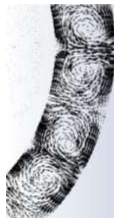
Рисунок 3 – Вихри, создающиеся в пространстве между трубами
