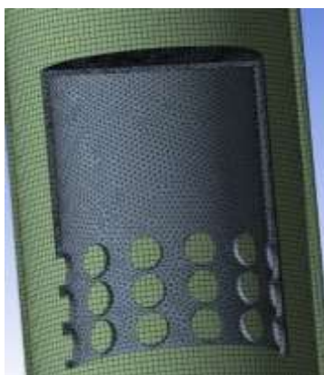
Рисунок 2 – Трехмерный вид внутренней трубы с отверстиями
