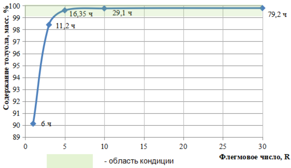
Рисунок 3 – Зависимость качества толуола от флегмового числа при постоянстве массы кубового остатка
