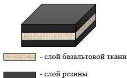
Рисунок 2 – Изображение армированного материала: слой эластомера – слой базальтовой ткани – слой эластомера
