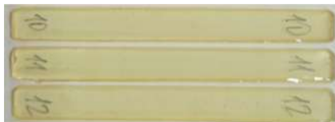
Рисунок 1 – Внешний вид образцов для испытаний на ударную вязкость
