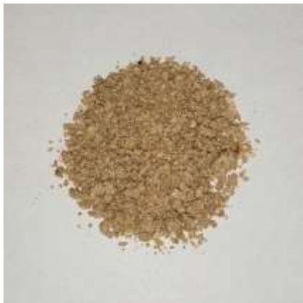
Рисунок 2 – Целлюлозный продукт, полученный кислотно-щелочным методом
