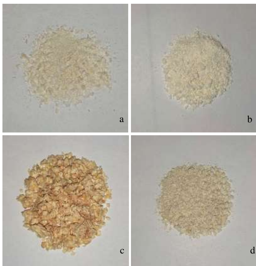
Рисунок 1 – Целлюлозные продукты, полученные пероксидным методом: а – 1 способ; б – 2 способ; с – 3 способ; д – 4 способ
